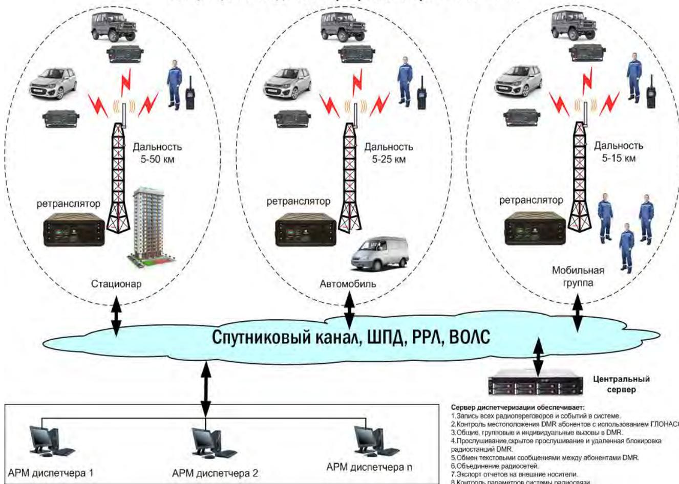
Концепция объединения ретрансляторов DMR Tier II по протоколу IP Multi-Site Connect.
