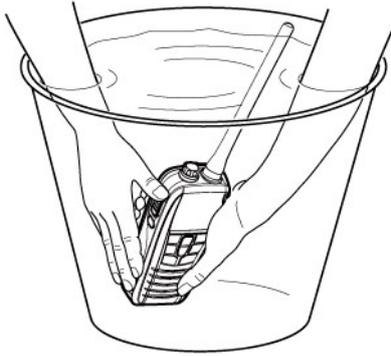
**ПРОМЫВАЙТЕ ПОВЕРХНОСТЬ ТРАНСИВЕРА ПРЕСНОЙ ВОДОЙ** после воздействия соленой воды и протрите ее, прежде чем приступать к эксплуатации. В противном случае, кристаллизация соли может воспрепятствовать работе органов управления устройства.
