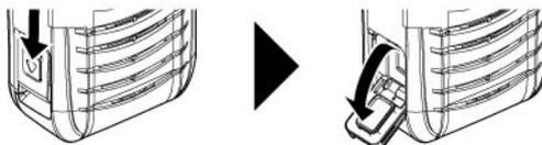
Сдвиньте вниз фиксатор крышки. Потяните крышку вниз и откройте ее.
