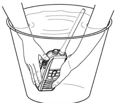
**ПРОМЫВАЙТЕ ПОВЕРХНОСТЬ ТРАНСИВЕРА ПРЕСНОЙ ВОДОЙ** после воздействия соленой воды и протрите ее, прежде чем приступать к эксплуатации.
