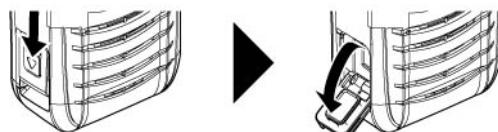
Сдвиньте вниз фиксатор крышки. Потяните крышку вниз и откройте ее.
