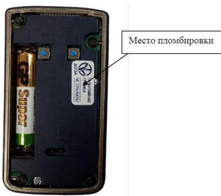
Рисунок 2 – Место пломбировки
