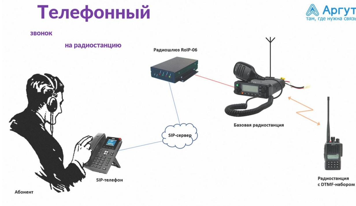
Рис. 6. Схема SIP-вызова радиостанции.
