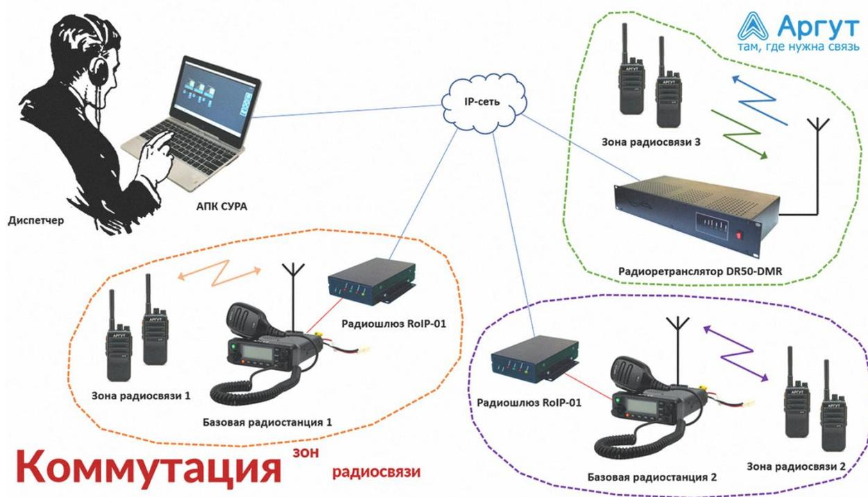
Рис. 5. Схема диспетчеризации.
