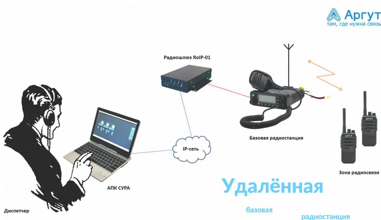
Рис. 4. Схема с удалённой радиостанцией.
