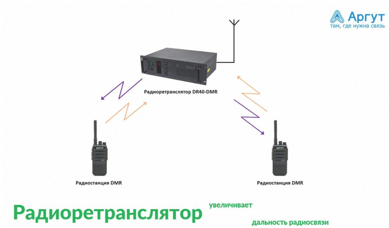
Рис. 1. Схема с радиоретранслятором.
