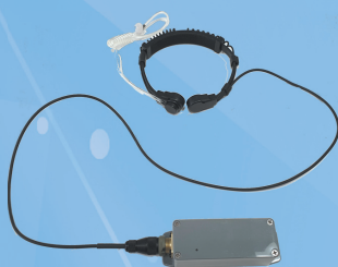
Варианты гарнитур «свободные руки (VOX)», позволяющие голосом переводить радиостанцию в режим передачи
