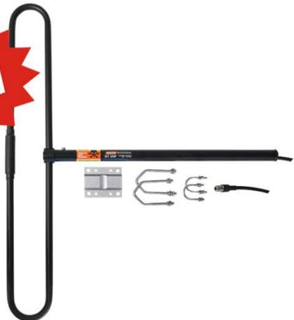
**Racio Antenna D1 VHF** 136-174 МГц, к.у. 3 dBi, 200 Вт, вертикальная поляризация, длина 3,2 м., материал – алюминиевый сплав, N-female.
