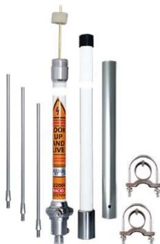
**Racio Antenna RU200V** 136-174 МГц, к.у. 6,7 dBi, 2\*5/8 λ, 200 Вт, вертикальная поляризация, длина 3,2 м., материал - стеклопластик, материал излучающего элемента - медь, PL-259. *Комплект: Антенна, Трубка, Противовесы, Хомуты.*
