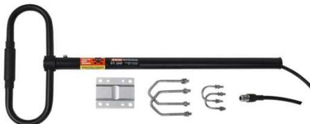
**Racio Antenna D1 UHF** 400-470 МГц, к.у. 3 dBi, 200 Вт, вертикальная поляризация, длина 3,2 м., материал – алюминиевый сплав, N-female.
