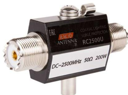
**Racio Antenna RC2500U** 0-2500 МГц, максимальная мощность от 1-350 МГц - 200 Вт, от 350 – 100 МГц – 100 Вт., при 1000 МГц и выше – 50 Вт., PL-259
