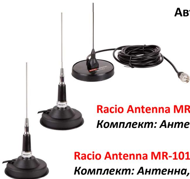
**Racio Antenna MR-14U** 136-500 МГц, к.у. 2,15 / 3,5 dBi, 150 Вт, излуч. элемент 1/4  $\lambda$  (VHF) / 3/4  $\lambda$  (UHF), PL-259. *Комплект: Антенна, магнитное основание с кабелем и разъёмом.*
