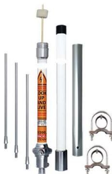
**Racio Antenna RU200U** 400-520 МГц, к.у. 12 dBi, 6\*5/8 λ, 200 Вт, вертикальная поляризация, длина 3,8 м., материал - стеклопластик, материал излучающего элемента – медь, PL-259. *Комплект: Антенна, Трубка, Противовесы, Хомуты.*
