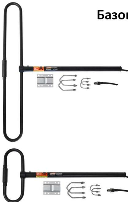
**Racio Antenna D1 VHF** 136-174 МГц, к.у. 3 dBi, 200 Вт, вертикальная поляризация, длина 3,2 м., материал – алюминиевый сплав, N-female.
