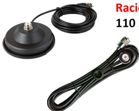
**Racio Antenna M110** Магнитное основание, прорезиненное, диаметр магнита 110 мм., длина кабеля 4,5 м.. Магнит - SO-239, разъём на кабеле - PL-259
