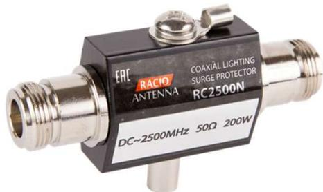
**Racio Antenna RC2500N** 0-2500 МГц, максимальная мощность от 1-350 МГц - 200 Вт, от 350 – 100 МГц – 100 Вт., при 1000 МГц и выше – 50 Вт., N-Type
